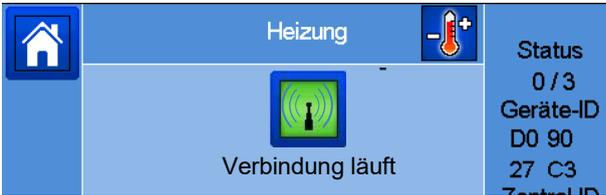
Bringen Sie den Funk-Empfänger in den Modus Funk-Paarung indem Sie die RF-Taste [📶] ca. 4 Sekunden gedrückt halten. Die LED Funk-Status leuchtet dauerhaft grün.
