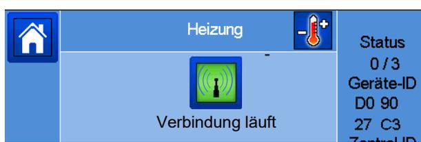
Bringen Sie den Funk-Empfänger in den Modus Funk-Paarung indem Sie die RF-Taste [📶] ca. 4 Sekunden gedrückt halten. Die LED Funk-Status leuchtet dauerhaft grün.
