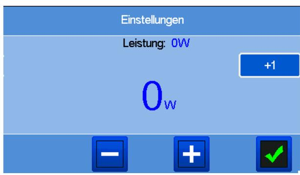
Falls es sich bei dem Gerät, welches an den Funk-Empfänger angeschlossen wird, um einen Elektro oder Infrarot Heizkörper handelt, können Sie hier die Leistung des Geräts angeben. Dadurch lässt sich an der Zentraleinheit eine Verbrauchsstatistik erstellen. Diese Funktion ist bei wasserführenden Systemen wie Heizkörper oder Flächenheizung/Kühlung leider nicht möglich.
