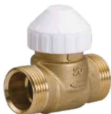
Válvula de dos vías en latón para ventiloconvector. Accionamiento ON/OFF mediante los actuadores de las **Series 22C, 22CX, 22CX5 y 26LC**. Temperatura máxima de trabajo: 110°C. Carrera del obturador: 2,5mm. PN 16bar.
