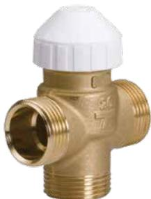
Válvula de tres vías en latón para ventiloconvector. Accionamiento ON/OFF mediante los actuadores de las Series 22C, 22CX, 22CX5 y 26LC. Temperatura máxima de trabajo: 110°C. Carrera del obturador: 2,5mm.
