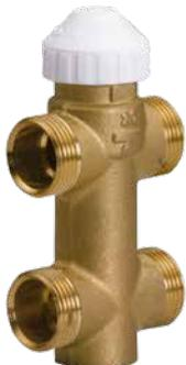
Válvula de tres vías con 4 acoplamientos en latón para ventiloconvector. Accionamiento ON/OFF mediante los actuadores de las **Series 22C, 22CX, 22CX5 y 26LC**. Temperatura máxima de trabajo: 110°C. Carrera del obturador: 2,5mm. Puede utilizarse tanto como válvula mezcladora que como válvula desviadora. PN 16 bar.
