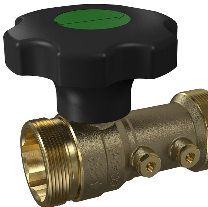
Il dispositivo BASIC CC di WATTS è una valvola antinquinamento di tipo EA dotata di valvola di ritegno sul lato valle, valvola a sfera integrata sul lato monte e quattro prese di pressione idonee all'installazione di spurghi o altri accessori. La valvola BASIC CC si può montare in tutti gli impianti che richiedono una protezione antinquinamento di tipo EA.
