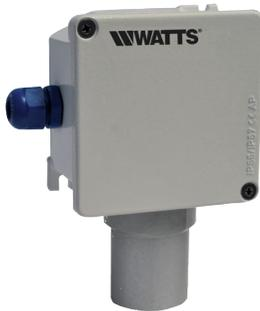
Detector de gas en caja metálica (protección grupo II, categoría 3G, ex nA IIC T6) con led indicador del estado de funcionamiento, para la señalización de alarmas de gas mediante salida analógica de 4÷20mA o en umbrales de intervención (prealarma, alarma de nivel 1 y 2, fallo) que pueden configurarse libremente mediante dip-switch.
