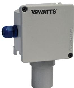
Rivelatore di gas in custodia metallica (modo di protezione gruppo II, categoria 3G, Ex nA IIC T6) con led di indicazione stato funzionale per la segnalazione di allarmi gas tramite uscita analogica 4÷20 mA o su soglie di intervento (preallarme, allarmi livello 1 e 2, guasto) liberamente impostabili tramite dip-switch.
