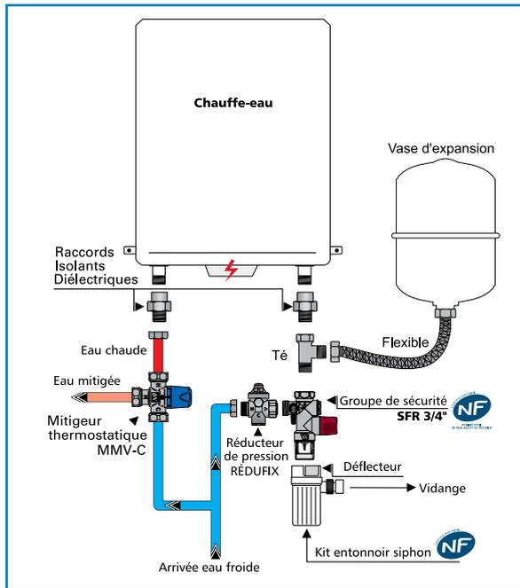
C : avec chauffe-eau à accumulation horizontal
