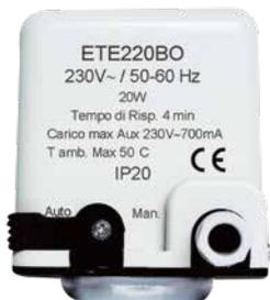
Attuatore elettrotermico ad azione on/off per valvole di zona **Serie VU**. Microinterruttore ausiliario normalmente aperto (NA) per comandi supplementari (es. pompa, contabilizzazione). Attacco a baionetta al corpo valvola. Dispositivo per il comando manuale. Assorbimento: 18W a 24V e 20W a 230V. Corsa: 5,5mm. Spinta dell'otturatore: 250N. Tempo di posizionamento: 4min.
