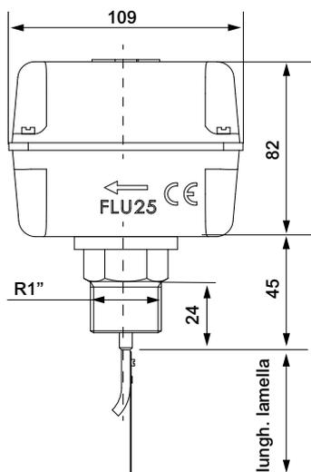
**Serie FLU25PL**-Flussostato per liquidi **Serie FLU25PL** marca WATTS per tubazioni da DN 1" a DN 8". Corpo in plastica. Raccordo in ottone. Microinterruttore a 3 contatti: 10(5)A - 230V. Pressione massima d'esercizio del fluido: 10 bar. Temperatura massima d'esercizio del fluido: 110°C. Temperatura massima dell'ambiente: 60°C. Provvisto di vite di regolazione della portata minima e massima. Conforme alla Direttiva LVD 2014/35/UE.
