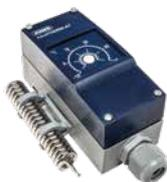
Il termostato determina l'inserimento o il disinserimento del cavo scaldante in funzione delle variazioni della temperatura ambiente. L'uso del termostato è raccomandato, poiché previene l'alimentazione costante del cavo scaldante, con conseguente riduzione dei consumi energetici e del rischio di surriscaldamento.
