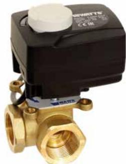
Valvola miscelatrice a settore a 3 vie completa di attuatore bidirezionale a 3-punti. PN 10 bar. Temperatura di esercizio: 0÷110°C. Corpo e rotore in ottone e guarnizioni in EPDM. Attacchi filettati F da 1/2" a 2". Angolo di rotazione 90° in 125 s.
