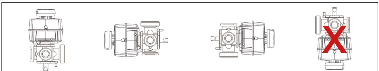
Cambiando la posizione dell'otturatore rispetto alla valvola è possibile ottenere diverse configurazioni della stessa per cui è importante, nella prima installazione, allineare i riferimenti della valvola e del motore.
