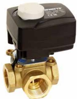
Valvola miscelatrice a settore a 4 vie completa di attuatore bidirezionale a 3-punti. PN 10 bar. Temperatura di esercizio: 0÷110°C. Corpo e rotore in ottone e guarnizioni in EPDM. Attacchi filettati F da 1/2" a 2". Angolo di rotazione 90° in 125 s. Alimentazione 230 V, 50 Hz; potenza max. 3 VA. Completa di cavo elettrico L=2 metri. Idonea per acqua con glicole fino al 50%.
