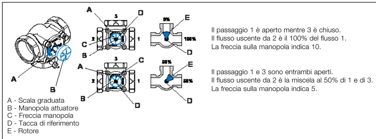
La placca in alluminio della valvola sui due lati riporta due scale graduate: una per la rotazione oraria ed una per la rotazione antioraria. Per passare da una all'altra è sufficiente svitare le due viti di fissaggio, ribaltare la placca e fissare nuovamente.
