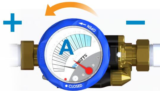
**ES:** Después de la puesta en marcha de la instalación, ajustar el caudal necesario en litros por hora (A) de acuerdo con los datos del proyecto. Girar la rueda de ajuste en sentido horario para aumentar el caudal y en sentido antihorario para disminuirlo.
