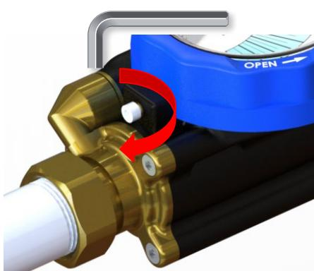
**SK:** Utiahnite skrutku, aby ste zablokovali ručné kolieso pomocou imbusového klúča 3 mm.
