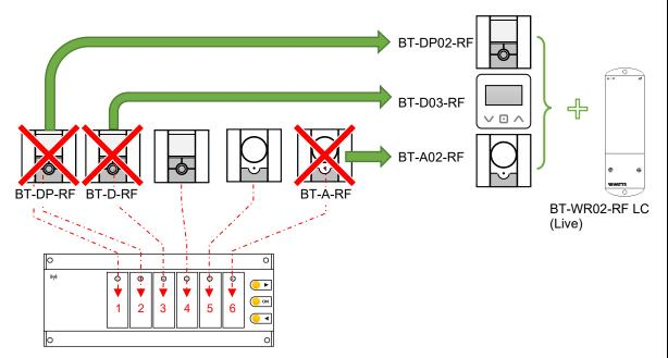
Den (defekten) Funk-Thermostat durch einen Funk-Thermostat der Serie Watts® Vision® in Kombination mit einem Einzel-Funkempfänger BT-WR02-RF LC (Live) austauschen und die entsprechenden Stellantriebe an diesen anschließen.
