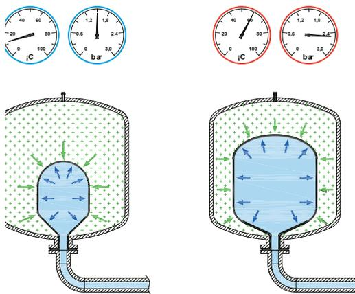
**Fig. 2** Posizione della membrana ad impianto inattivo
