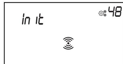
Wenn sich der Thermostat in der Funk-Kopplungsphase befindet, sendet er ohne Unterbrechung bidirektionale Kopplungsframes (Paarungssignale).
