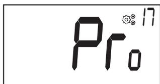
Dieses Menü erlaubt den Zugriff auf die Parametermenüs des Installateurs. Durch Drücken und Halten der Taste
