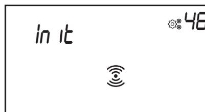
Lorsque le thermostat est à l'étape d'initialisation de la communication sans fil, il envoie des images d'appairage bidirectionnelles sans discontinuité.
