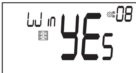
Lorsqu'elle est activée et qu'une détection est en cours d'exécution, l'icône apparaît et clignote à l'écran! ; Cette fonction se fait en mesurant et en enregistrant l'évolution de la température.
