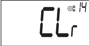
Halten Sie zum Zurücksetzen die Taste
