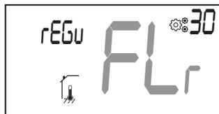
“FLL” : Régulation avec sonde de sol et sonde d'air
