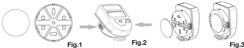
Per rimuovere l'integratore dal supporto della parete, sarà sufficiente premere lateralmente sui due pulsanti di bloccaggio. Riavvitare il cavo di connessione nella posizione fornita sul flussometro (1) e reinserire l'integratore (2).
