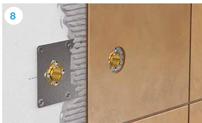
8 Grazie allo spessore ridotto della piastra è possibile annegarla nella colla per l'incollaggio delle piastrelle. Si consiglia di prevedere l'applicazione di uno strato impermeabilizzante sulla piastra metallica.
