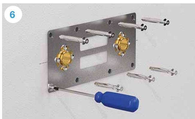
6 Fissare la piastra tramite i 4 tasselli forniti nella confezione. Serrare le viti portando a completa espansione i tasselli. Per eliminare eccessive sporgenze rimuovere le viti dai tasselli.
