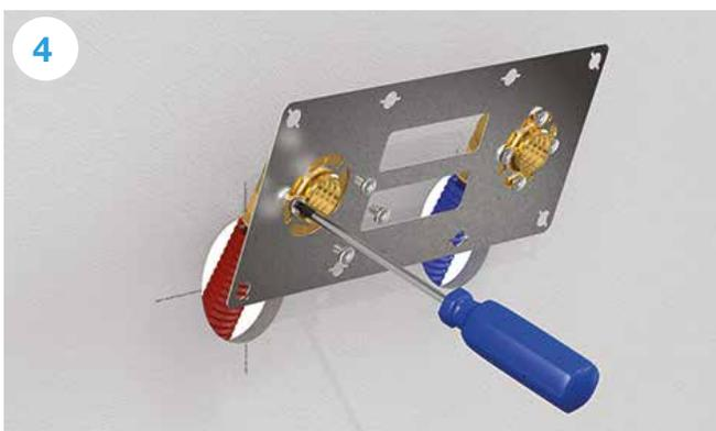
Fissare i raccordi alla piastra senza serrare le viti (viti in dotazione). Non piegare il tubo multistrato. Effettuare la prova di tenuta idraulica prima del fissaggio definitivo.
