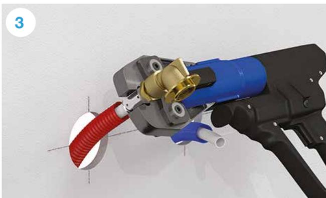
Inserire il tubo multistrato nel raccordo fino a battuta e pinzare usando inserti con profilo U-H-TH.
