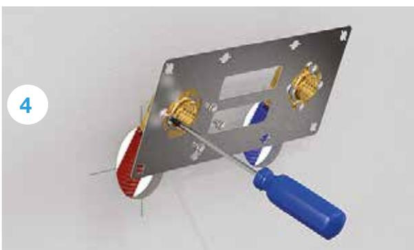
Fije el accesorio a la placa sin apretar los tornillos (tornillos suministrados). No doblar el tubo multicapa. Realice la prueba de estanqueidad hidráulica antes de la fijación definitiva.
