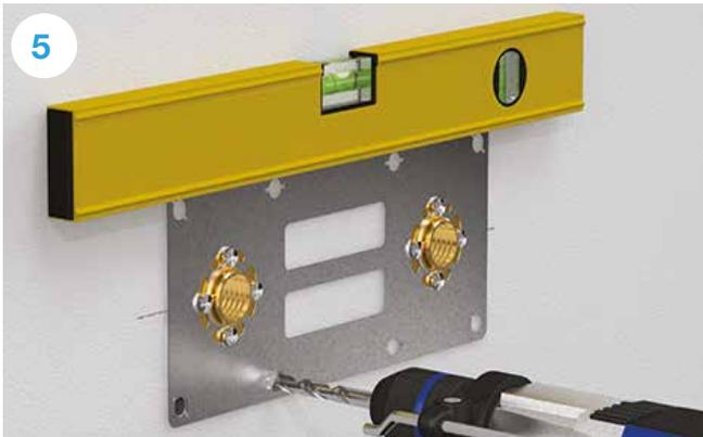
Coloque la placa en posición horizontal y taladre 4 orificios (Ø8 mm) para su fijación.
