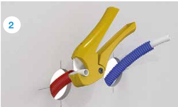
Saque los tubos multicapa de la pared, ajuste su longitud cortando los extremos con tijeras, asegurándose de hacer un corte de 90°.
