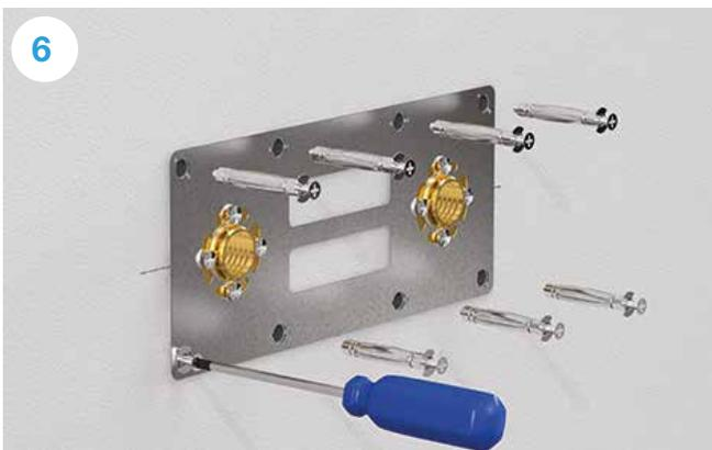
Fije la placa con los 4 tacos suministrados en el paquete. Apriete los tornillos hasta que las espigas estén completamente expandidas. Para eliminar un voladizo excesivo, retire los tornillos de las espigas.
