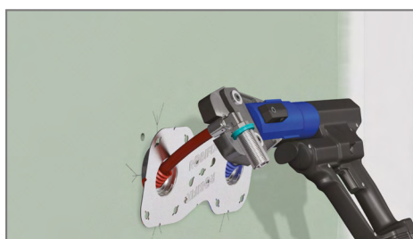
RACCORD PER À SERTIR (outillage pince à sertir, mâchoires "H" et "RF")
